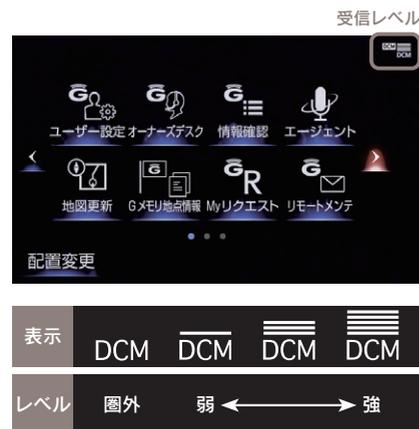
受信レベル表示が「圏外」と表示されている場合でも、車載機(ナビ)はデータ取得動作を行います。一定時間経過してもデータ取得できない場合は、自動的に中止します。中止までの時間は車載機(ナビ)の通信状態によって異なります。
