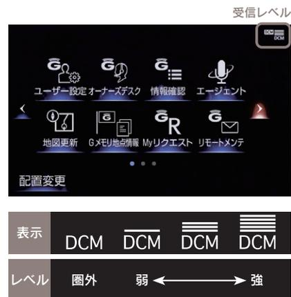
受信レベル表示が「圏外」と表示されている場合でも、車載機はデータ取得動作を行います。一定時間経過してもデータ取得できない場合は、自動的に中止します。中止までの時間は車載機の通信状態によって異なります。
