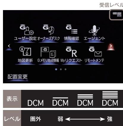
受信レベル表示が「圏外」と表示されている場合でも、車載機はデータ取得動作を行いますが、一定時間経過してもデータ取得できない場合は、自動的に中止します。中止までの時間は車載機の通信状態によって異なります。
