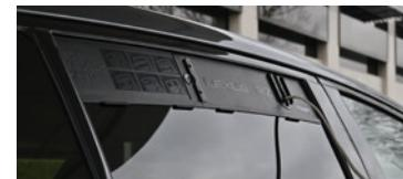
外部給電アタッチメントを使用すれば、車内への雨水や虫などの侵入を低減しつつ車外へ電源コードを出し、車の外で電気を使用することができます。
