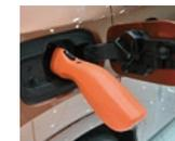
PHEV車では、非常時給電システムに加え、AC外部給電システムでクルマから外部に給電できます。
