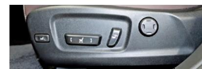
シート操作は座面横の電動式レバーで調整が可能です。
