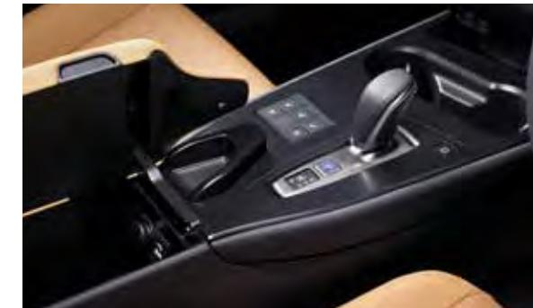
電子機器の充電が可能です。フロントトレイは大型スマートフォン(長さ約175mm×幅約85mm)も収納できるスペースを確保。LED照明および収納物を保護するゴムマット付きです。おくだけ充電\*を選択した場合は、フロントトレイがおくだけ充電のスペースとなります。フロントセンターコンソールボックス内には、充電・通信用USB Type-A端子を1個、アクセサリーソケット(DC12V・120W)を設置しています。
