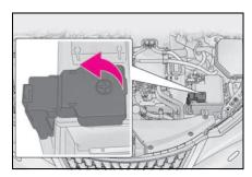
4 赤色のブースターケーブルを自車の+端子A につなぎ、もう一方の端を 救援車のバッテリーの+端子B につなぐ。その後、黒色のブースター ケーブルを救援車のバッテリーの-端子C につなぎ、もう一方の端を金 属部D につなぐ ブースターケーブルは、指定の端子および接続箇所に届くものを使用して ください。
