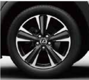
225/50R18ランフラットタイヤ& アルミホイール(切削光輝+ダークグレーメタリック塗装)
