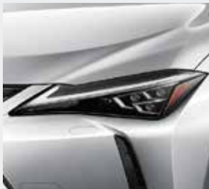
三眼フルLEDヘッドランプ(ロー・ハイビーム)& LEDフロントターニングシグナルランプ+アダプティブハイビームシステム(AHS)+ヘッドランプクリーナー
