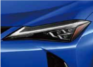
三眼フルLEDヘッドランプ(ロー・ハイビーム)& LEDフロントターンシグナルランプ+アダプティブハイビームシステム(AHS)+ヘッドランプクリーナー “F SPORT”
