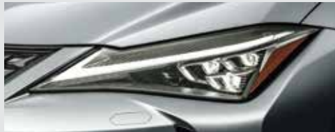
三眼フルLEDヘッドランプ(ロー・ハイビーム)& LEDフロントターンシグナルランプ+アダプティブハイビームシステム[AHS]+ヘッドランプクリーナー
