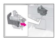
コネクターロック緊急解除レバーを操作 した後は、「カチッ」と音が鳴るまで押し
