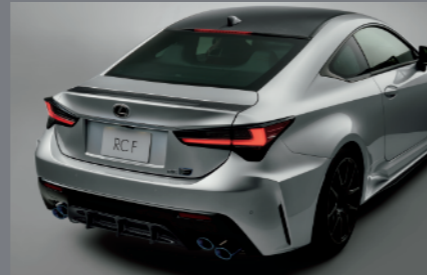
カーボンルーフ/カーボンアクティブリアウイング(格納式)/カーボンリヤティフューザー
