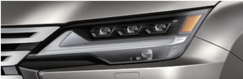
三眼フルLEDヘッドランプ（ロー・ハイビーム）& LEDフロントターンシグナルランプ
