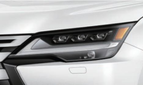
三眼フルLEDヘッドランプ（ロー・ハイビーム）& LEDフロントターンシグナルランプ
