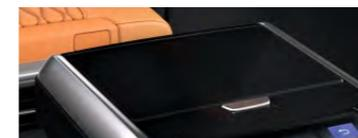
テーブルの表面にはペン跡などの傷が回復しやすい自己治癒塗料を使用。テーブル面を押し込んでも開かない構造のため、書類へのサインなどに使うことができます。
