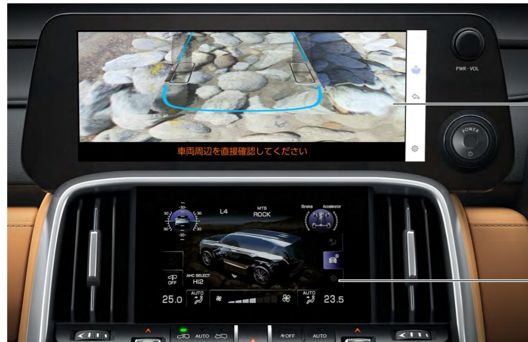
マルチテレインモニターのバックアンダーフロアビュー(拡大)画面
