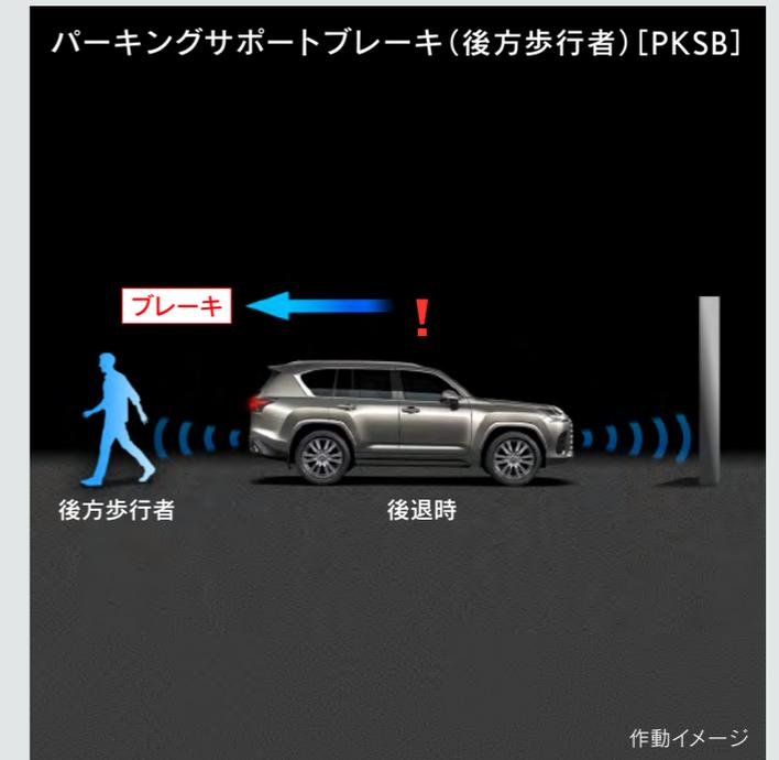
アクセルの踏み間違いや踏みすぎなどで起こる衝突を緩和し、被害の軽減に寄与するシステムです。静止物の検知対象を前後進行方向のみならず、側方を加えた車両周囲にまで拡大。Lexus Teammate Advanced Parkのアシスト中だけでなく、出庫や後退中のような駐車シーンにおいても周囲を監視しながら静止物の接近を表示とブザーで知らせ、さらに距離が縮まると衝突被害軽減ブレーキをかけます。
