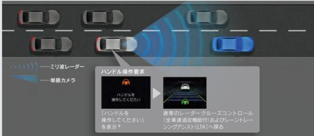
渋滞が解消し、Lexus Teammate Advanced Drive (渋滞時支援)終了時は、ドライバーにハンドル操作を促すために、マルチインフォメーションディスプレイの表示とブザーで通知し、支援を終了します。
