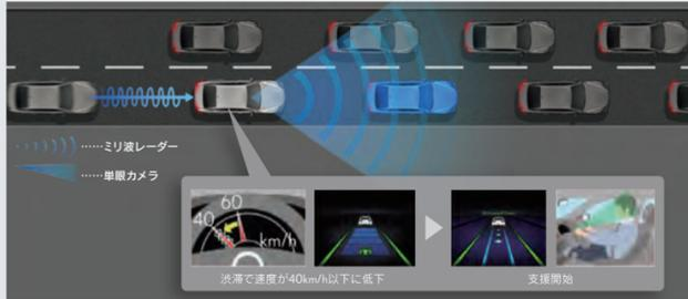
Lexus Teammate Advanced Drive (渋滞時支援)は、渋滞を検知するとマルチインフォメーションディスプレイ表示によるお知らせの後、自動的に支援を開始します。渋滞を検知し、ドライバーが周囲を監視している状態で自車速度が約40km/h以下になるとマルチインフォメーションディスプレイに“Advanced Drive”と表示し、車線維持・加減速・停車・発進を支援します。
