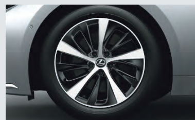
245/50R19タイヤ & ノイズリダクションアルミホイール (切削光輝+ブラック塗装)
