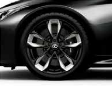
フロント245/40R21+リヤ275/35R21タイヤ & 鍛造アルミホイール (ブラック+ハイパークロムメタリック塗装)*1
