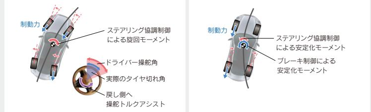
アクティブステアリング制御を付加することで、旋回方向のモーメントを増加。さらにEPSによって前輪の切り戻し方向に操舵トルクをアシストし、過度な切り込み操舵を抑制。
