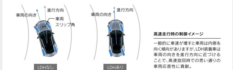
一般的に車速が増すと車両は内側を向く傾向がありますが、LDH装着車は車両の向きを進行方向に近くすることで、高速旋回時での思い通りの車両応答性に貢献。
