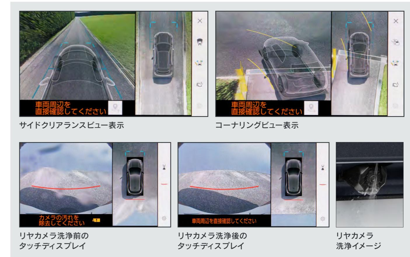
\*事前にセンターディスプレイの設定で床下透過がONになつていれば、パノラミックビューモニター(床下透過表示機能付)を表示すると自動的に(車両を動かすと同時に)床下透過表示になります。
