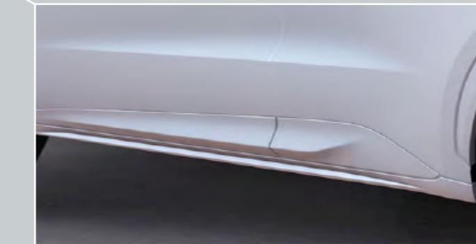
②ロッカーモール下端フィン形状によりフラット感を向上・旋回時のロールを抑制
