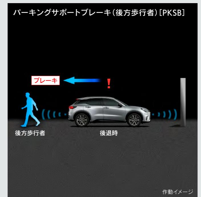
アクセルの踏み間違いや踏みすぎなどで起こる衝突を緩和し、被害の軽減に寄与するシステムです。Lexus Teammate Advanced Park/Advanced Park(リモート機能付)装着車では、静止物の検知対象を前後進行方向のみならず、側方を加えた車両周囲にまで拡大。Lexus Teammate Advanced Park/Advanced Park(リモート機能付)のアシスト中だけでなく、出庫や後退中のよう駐車シーンにおいても周囲を監視しながら静止物の接近を表示とブザーで知らせ、さらに距離が縮まると衝突被害軽減ブレーキをかけます。
