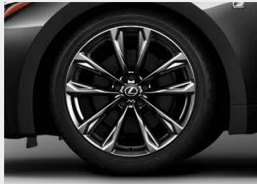
フロント235/40R19+リヤ265/35R19タイヤ& アルミホイール(ブラックS/Patterning塗装) *1*2 IS300h IS300
