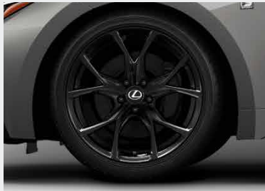
フロント235/40R19+リヤ265/35R19タイヤ& 鍛造アルミホイール(BBS製ブラック塗装) *2*8
