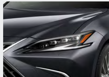
三眼フルLEDヘッドランプ(ロー・ハイビーム) & LEDターンシグナルランプ(フロント)
