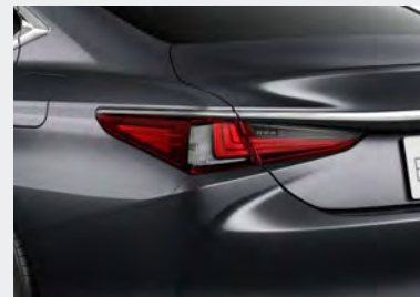
フルLEDリヤコンビネーションランプ (テール・ストップ・バックアップ・ターンシグナル)
