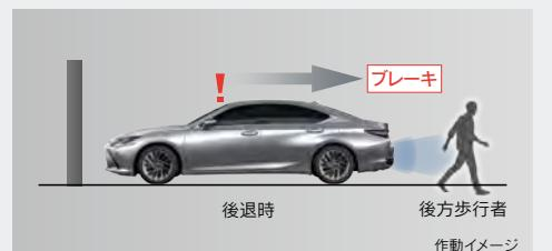
後退して出庫する際、自車後方の歩行者の存在を、12.3インチディスプレイオーディオ(コネクティッドナビ対応)Plus、およびリヤブザーでお知らせします。自車後方の歩行者と衝突する可能性が高いと判断した場合、衝突被害軽減ブレーキをかけます。
