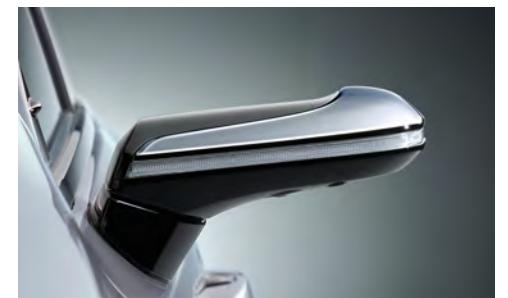
高性能アウターカメラの採用により、明暗が混在する場所でもノイズ低減処理と合わせて、ノイズ感の少ないクリアな映像を実現。またLEDライトを映す際に起こるちらつきによる煩わしさを低減しました。
