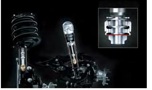
サスペンションのストローク速度が極めてゆっくりな場合から最適な減衰力を発生するスwingバルブショックアブソーバーを採用しています。
