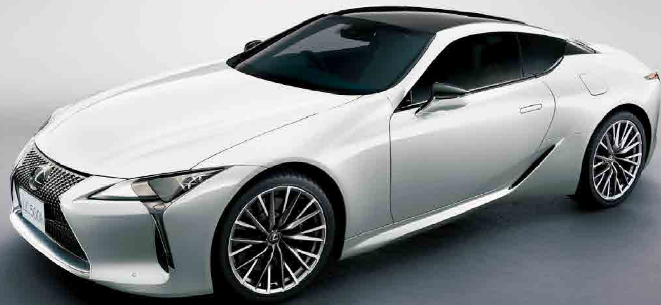
Photo: LC500h “L package”。ボディカラーはホワイトノーヴァガラスフレック(083)。フロント245/40R21+リヤ275/35R21タイヤ&鍛造アルミホイール(切削光輝+スーパーグロスブラックメタリック塗装)はメーカーオプション。
