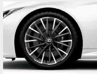
フロント245/40R21+リヤ275/35R21タイヤ&鍛造アルミホイール(切削光輝+スーパーグロスブラックメタリック塗装)*1
